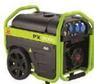
La gamma PX rappresenta una delle ultime novità PRAMAC. Compatti, efficienti e facili da usare, i generatori PX sono perfetti per tutte le vostre applicazioni semiprofessionali. Erogazione Frequenza Hz 50, Tensione V 230, Fattore di potenza  $\cos \phi$  0.9, Fasi 1. Potenza nominale massima LTP kVA 6.0, Potenza nominale massima LTP kW 5.4, Potenza nominale in servizio continuo COP kVA 5.0, Potenza nominale in servizio continuo COP kW 4.5
