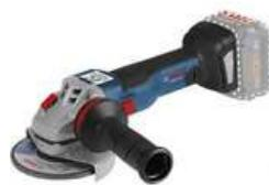
Numero di giri a vuoto 9.000 giri/min; Tensione della batteria 18 V; Filettatura dell'alberino M 14; Ø foro 22.23 mm; Peso escl. batteria 2 kg; Dimensioni della confezione (larghezza x lunghezza x altezza) 165 x 395 x 139 mm; Peso incl. batteria 2.8 kg; Mola da sgrasso/per troncare, Ø 125 mm; Ø platorello in gomma 125 mm.
