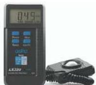
Livello di illuminamento - normativa CEI EN 61326-1 - display LCD 3½ dgt. (1999 conteggi) - portata fotometrica 400÷700 nm - massima sensibilità dello spettro luminoso 550 nm - portate di misura 200/2000/20000 - precisione base ± 4%rdg. ± 5 dgt
