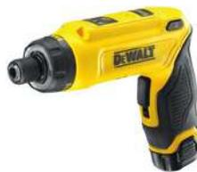
Batteria Lito; Voltaggio 7.2 V; Capacità batteria 1 Ah; coppia di serraggio 4 Nm; Velocità a vuoto 0 - 430 Giri/min; Attacco 6.35 mm; peso 0.5 Kg; Lunghezza 165 / 245 mm; Altezza 135 / 55 mm; Vibrazioni mano/braccio < 2.5 m/s<sup>2</sup>; incertezza (Vibrazioni) 1.5 m/s<sup>2</sup>; Potenza sonora 60 dB(A); Incertezza (Potenza sonora) 3.7 dB(A); Pressione acustica 71 dB(A); Incertezza (Potenza sonora) 3.7 dB(A); Dotazione 2x batterie 7.2V Lito; Caricabatterie 7.2V; Valigetta
