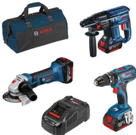
**Tassellatore** alimentazione batteria; motore brushless; potenza 18 v; Tipologia batteria Litio; Attacco Sds-plus; Funzioni 3 (rotazione, rotazione + percussione, percussione); Capacità foro 21 mm calcestruzzo; 13 mm acciaio, 30 mm legno; Potenza del colpo 2 J; Velocità a vuoto 0 - 1.800 g/min; Colpi al minuto 0 - 5100; Caricabatterie; Interruttore elettronico Si; Reversibile Si; Led illuminazione Si; Utilizzo Edilizia; Dimensione 330x210 mm; Peso 2.4 kg senza batteria
