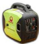
Tecnologia Inverter ideale per l'alimentazione di apparecchiature elettroniche sofisticate e sensibili alle variazioni di tensione e frequenza. Sistema di controllo e regolazione elettronico dei giri in funzione del carico che ottimizza consumi, rumore, emissioni dei gas di scarico e protegge il circuito da sovraccarichi e sbalzi di tensione/frequenza. Potenza LTP kW 2.00 Potenza COP kW 1.60 Tensione V 230 Frequenza Hz 50 Fattore di potenza  $\cos \phi$  1
