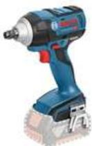
Numero di giri a vuoto 0-2.400 giri/min; Coppia, max. 250 Nm; Numero di colpi 0-3.500 colpi/min; Tensione della batteria 18 V; Portautensili Sezione quadrata esterna da 1/2"; Dimensioni dell'utensile (larghezza) 64 mm; Dimensioni dell'utensile (lunghezza) 163 mm; Dimensioni dell'utensile (altezza) 246 mm; Dimensioni della confezione (larghezza x lunghezza x altezza) 360 x 440 x 160 mm; Capacità della batteria 5 Ah; Peso incl. batteria 1,9 kg; Diametro vite; Ø viti M 10 - M 18; SENZA BATTERIA
