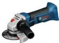
Numero di giri a vuoto 10.000 giri/min; Tensione della batteria 18 V; Dimensioni della confezione (larghezza x lunghezza x altezza) 365 x 402 x 150 mm; Peso incl. batteria 2,3 kg; Mola da sgrasso/per troncare, Ø 115 mm; Ø platorello in gomma 115 mm;
