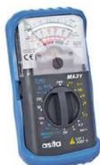
Tensione DC+AC - corrente continua DC - resistenza - decibel dB - normativa CEI EN 61010-2-030 - normativa CEI EN 61326-1 - normativa CEI EN 61010-1 - normativa CEI EN 61010-031- temperatura di utilizzo da 0°C a +40°C - categoria di misura CAT-II 250V - grado di protezione IP20 alimentazione 1 batteria LR6 - dimensioni e peso 65x130x40mm / 200g.
