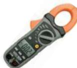
Campo di misura corrente 600A; Corrente AC; Tensione AC/DC 600V; resistenza e test continuità con cicalino; Prova Diodi ;Categoria di misura CAT III; EMC 2014/30/EU; EMC: IEC/EN61326; IEC/EN61010-1; LVD 2014/35/EU; MARCATURA CE
