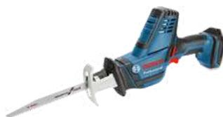
Profondità di taglio in legno 200 mm; Profondità di taglio in profilati e tubi metallici 100 mm; Lunghezza corsa 21 mm; Tensione della batteria 18 V; Numero di corse (1ª velocità/2ª velocità) 0 - 3.050 corse/min, Dimensioni della confezione (larghezza x lunghezza x altezza) 360 x 440 x 155 mm; Capacità della batteria 5 Ah; Peso incl. batteria 2,5 kg
