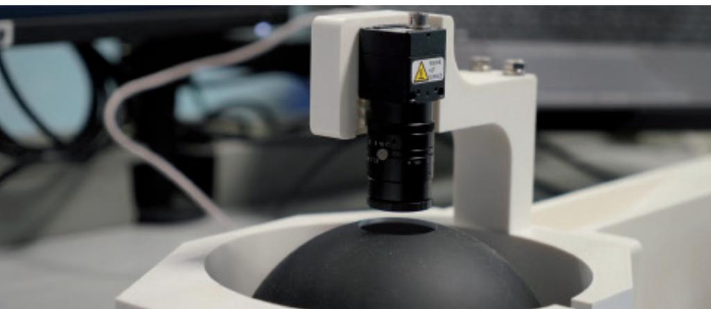
IMA Active, divisione di IMA Group dedicata alla produzione di sistemi e macchine automatiche per l'industria farmaceutica, ha recentemente aggiornato la sua soluzione per il rivestimento in continuo delle compresse grazie all'innesto di un sistema di visione OMRON dotato di videocamera a colori ad alta velocità e illuminatore "Dome". Il risultato è una valutazione molto accurata dell'uniformità del rivestimento, sia sulla superficie della singola compressa che tra le compresse.
