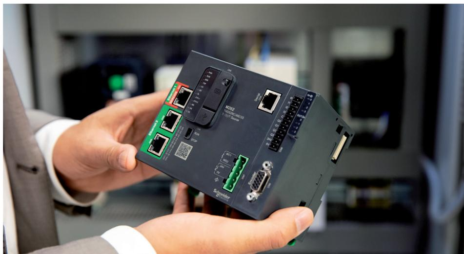
Onboard vi sono 8 I/O veloci, un QRCode che consente di identificare la macchina univocamente e di connettersi a risorse digitali per la manutenzione. Completano la dotazione del prodotto l'interruttore run/stop, il connettore per le espansioni I/O Modicon TM3 e lo smart communication bus per aggiungere i moduli di comunicazione Ethernet o Canopen, su tutte le versioni motion è presente un ingresso encoder incrementale o assoluto SSI.
